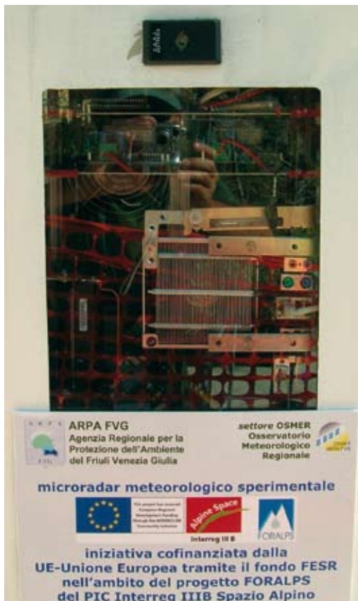
7. Dettaglio di un radar in banda X a scansione verticale (fonte: OSMER).
